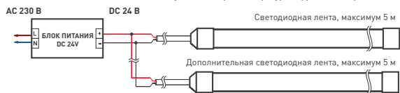
Схема 2. Подключение лент к источнику питания при температуре окружающей среды более +40 °C
