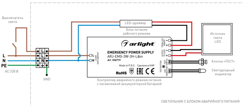
Рис. 3. Электрическая схема подключения моделей с БАП 036719
