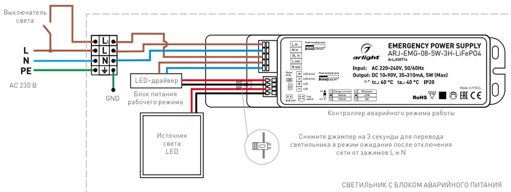
Рис. 5. Электрическая схема подключения моделей с БАП 030714
