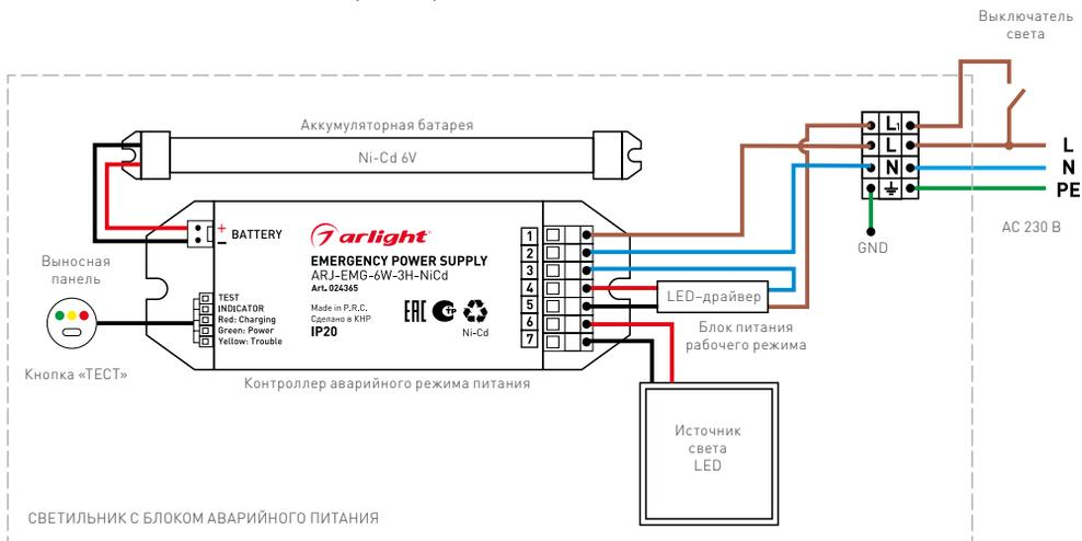
Рис. 4. Электрическая схема подключения моделей с БАП 024365
