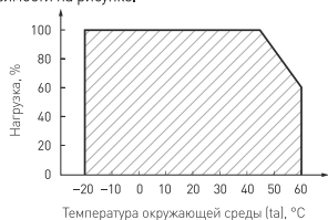
Рис. 1. Максимальная допустимая нагрузка, % от мощности источника
