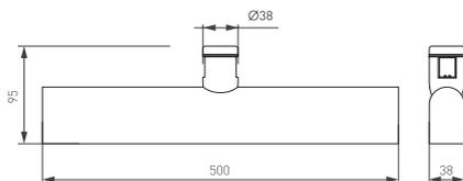
Рис. 1. Чертеж и габаритные размеры
