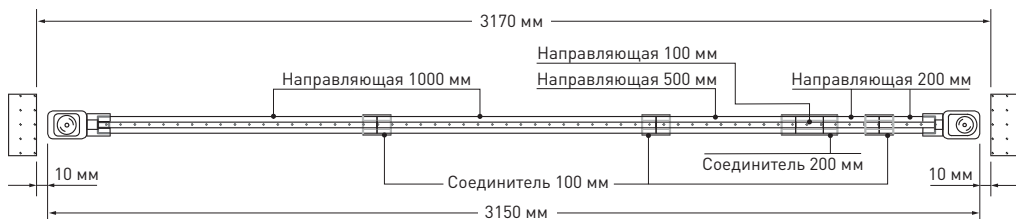
Рис. 3. Пример сборки направляющей длиной 3.15 м
